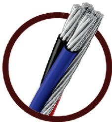
**Condutor:** Cabo de alumínio compactado bloqueado ou não, têmpera mole classe 2, com cobertura em XLPE 90°C, com especiais características anti-trilhamento (Anti Tracking).
